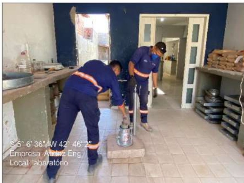
Figura 2 – Solo sendo compactado.
